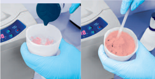
Nadávkuje množství prášku a vody podle předpisu.
