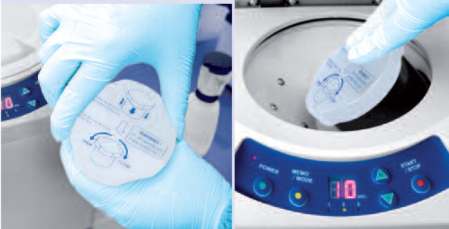
Dejte naplněnou a uzavřenou míchací misku do mixeru.
