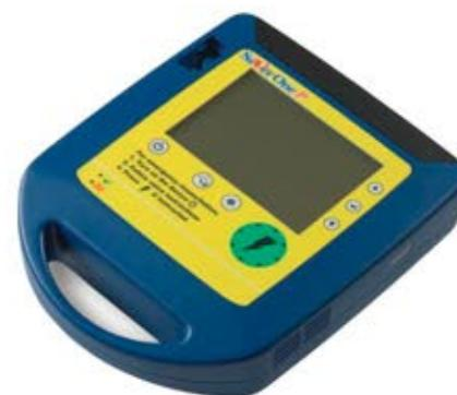
*Defibrilátory řady SAVER ONE* mohou být napájeny dvěma způsoby: jednorázovými bateriemi (LiMnO<sub>2</sub>) nebo akumulátory (Li-Ion). U osob postižených komorovou fibrilací (VF) nebo komorovou tachykardií (VT) doporučí jeden nebo více výbojů.
