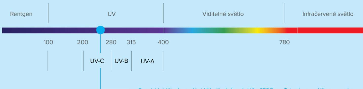
Germicidní účinek vyvolává UV záření vlnové délky 253,7 nm. Tuto vlnovou délku generuje germicidní výbojka. Jedná se o rezonanční kmitočet rtuti, při kterém ještě nedochází plně k tvorbě ozonu. Při aktivaci germicidního zářiče můžeme cítit tzv. přepálený vzduch, který není škodlivý, nejedná se však o ozon. Ozon má v malých dávkách příjemnou svěží vůni.
